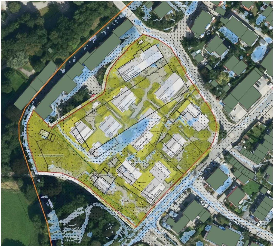
Abbildung 4: Fließweganalyse IST T = 100 a (Quelle: FWA Ingenieurbüro Kokai GmbH Oktober 2025)
